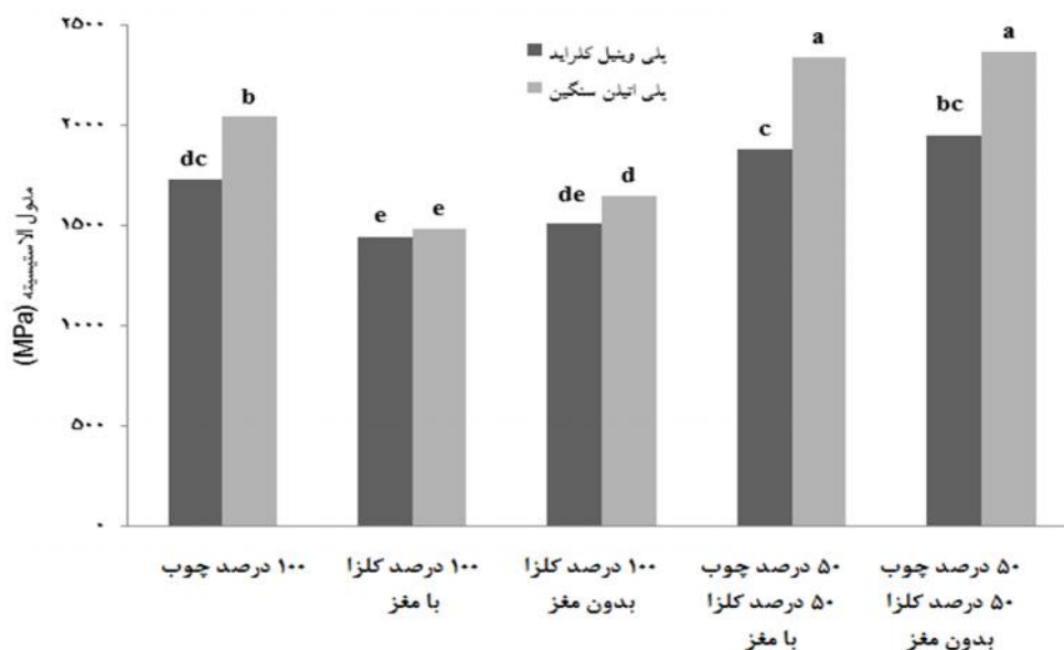
شکل ۴- اثر متقابل نوع پلیمر و ماده لیگنوسلولزی بر مدول الاستیسیته چندسازه چوب پلاستیک
