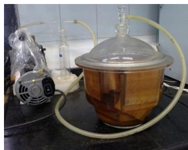
شکل ۱- نحوه انجام فرایند استیلایسیون به کمک دسیکاتور و پمپ خلأ
