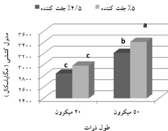
شکل ۱- اثر متقابل طول ذرات میکرو سلولز و درصد جفت‌کننده بر مقاومت و مدول کششی چندسازه
