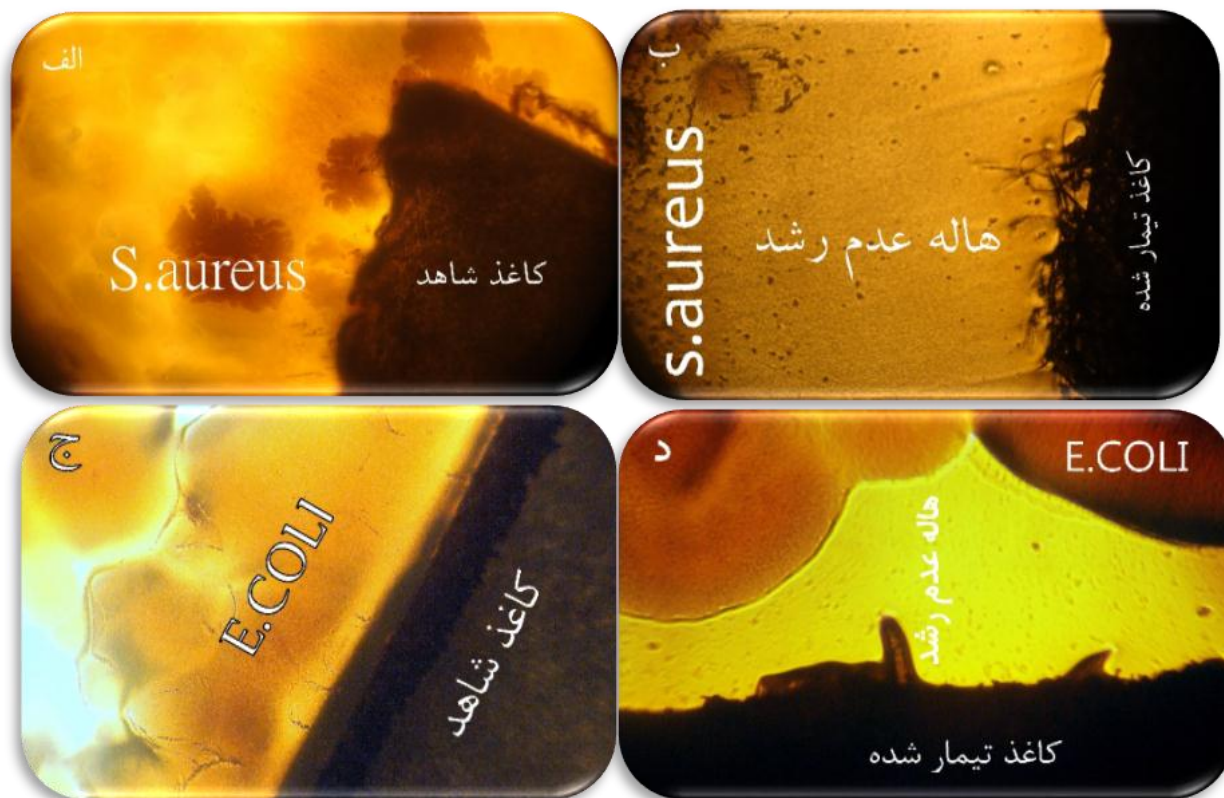
شکل ۷- تصویر میکروسکوپ نوری (بزرگ نمایی 4x) کاغذهای تیمار شده با نانو نقره و شاهد: الف: شاهد استافیلوکوکوس؛ ب: تیمار شده با نانو نقره برای استافیلوکوکوس؛ ج: شاهد اشرشیاکلی؛ د: تیمار شده با نانو نقره برای اشرشیاکلی
