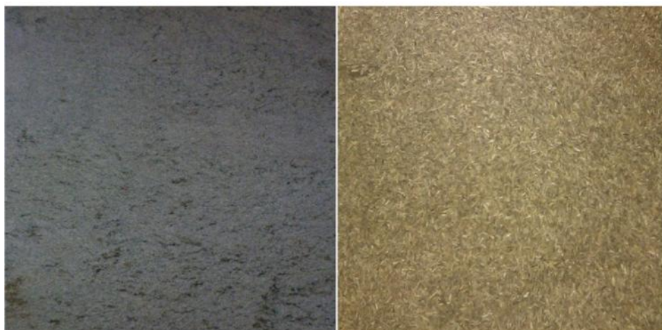
شکل ۱- آرد چوب قبل (سمت راست) و بعد (سمت چپ) از تیمار آهکی
