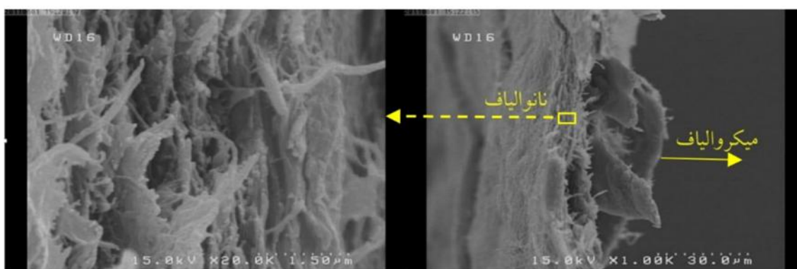
شکل ۱۲- ریزنگاره الکترونی سطح شکست پارگی کاغذ حاوی ۵۰ درصد سلولز نانوفیبریله شده
