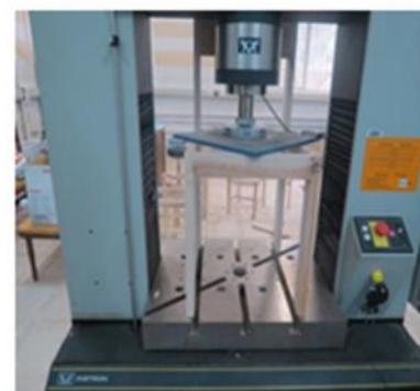
شکل ۸- بارگذاری و شکست در صندلی با اتصالات کام و زبانه و دوبل در دستگاه آزمون مکانیکی
