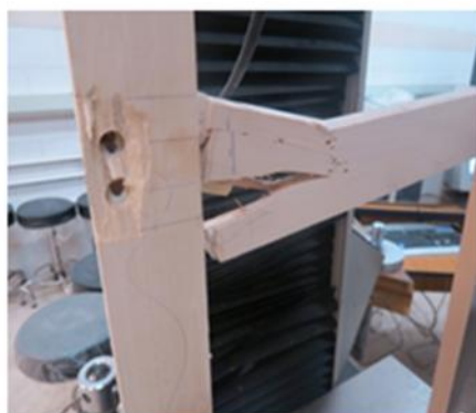
شکل ۸- بارگذاری و شکست در صندلی با اتصالات کام و زبانه و دوبل در دستگاه آزمون مکانیکی
