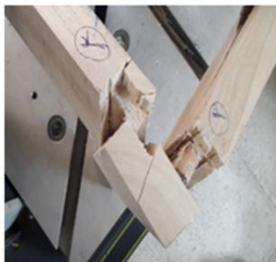
شکل ۸- بارگذاری و شکست در صندلی با اتصالات کام و زبانه و دوبل در دستگاه آزمون مکانیکی
