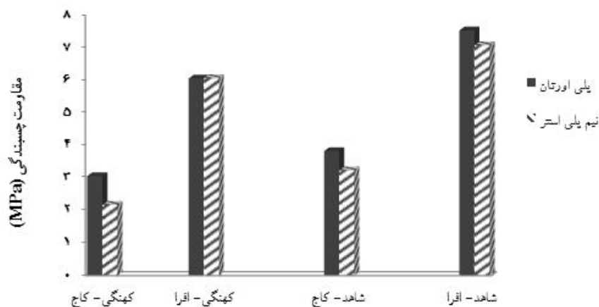
شکل ۴- تأثیر متقابل گونه چوبی و نوع شفاف پوشه و کهنگی تسریع شده بر مقاومت چسبندگی
