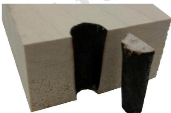
شکل ۲- برش طولی از یک اتصال جوشکاری شده
