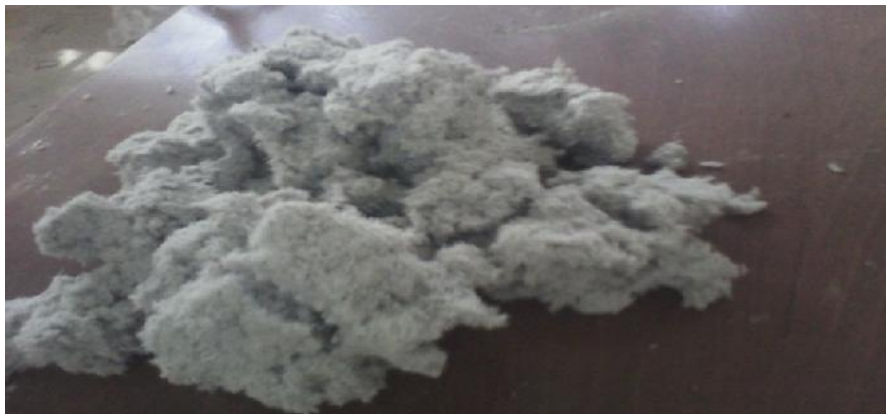
شکل ۲- الیاف تهیه شده از روزنامه باطله
