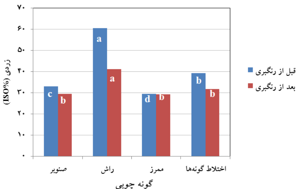
شکل ۷- اثر گونه چوبی بر زردی خمیرکاغذ شیمیایی - مکانیکی پالایش شده قبل و بعد از رنگ‌بری (BR)
