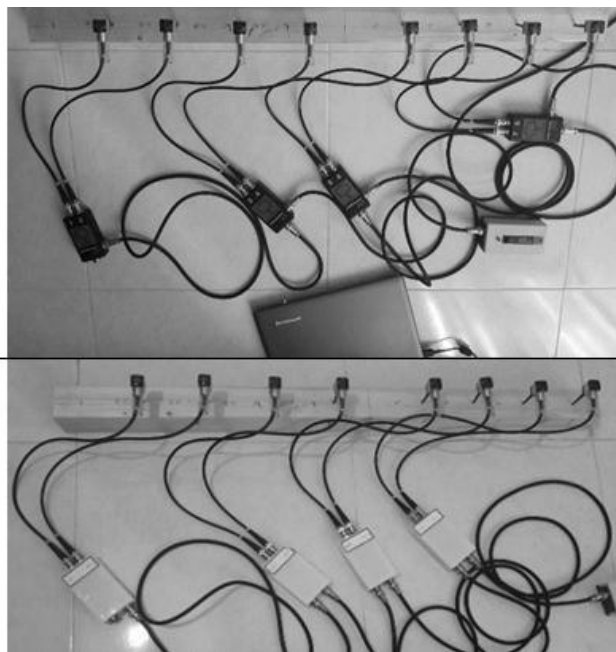
شکل ۳- آزمون همزمان دستگاه داخلی با دستگاه اروپایی، روی قطعه چوب طولی (تصویر راست) و تنه بریده درخت (تصویر چپ)
