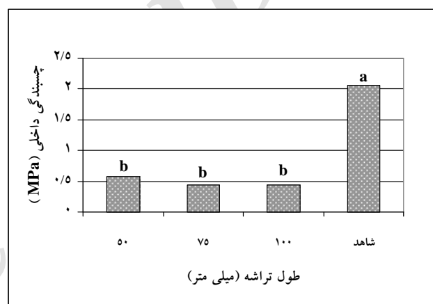
شکل ۶- اثر طول تراشه بر مقاومت چسبندگی داخلی تخته‌تراشه
