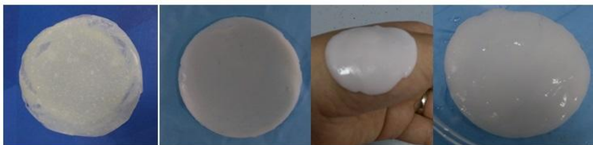
شکل ۲- تصویر هیدروژل در زمان بررسی واکسیدگی: از چپ به راست نمونه خشک، بعد از ۵ دقیقه، ۵ ساعت و ۲۴ ساعت
