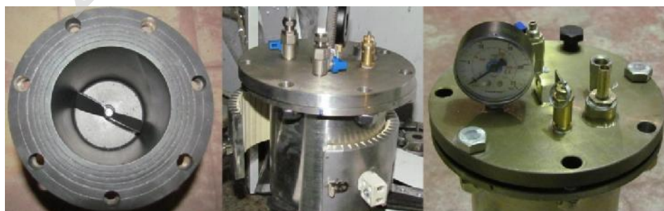
شکل ۱- محفظه واکنش و سیستم گرمایشی دستگاه ساخت داخل
