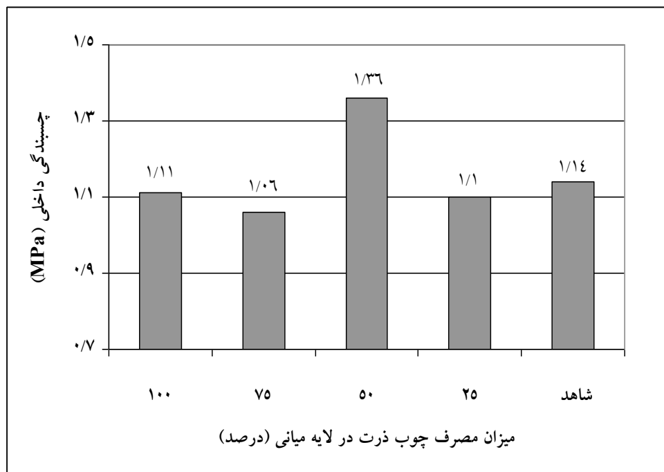
شکل ۵- اثر میزان مصرف چوب ذرت در لایه میانی بر مقاومت چسبندگی داخلی
