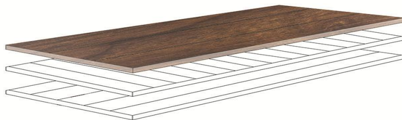
شکل ۲- نمایی از قرار گرفتن لایه‌ها در تخته لایه
