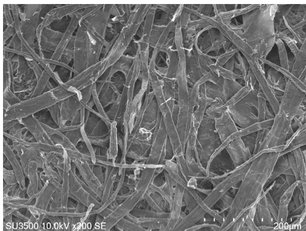
شکل ۳- تصویر SEM با بزرگنمایی ۲۰۰ از الیاف کاغذ باطله بدون تیمار آنزیمی و پالایش
