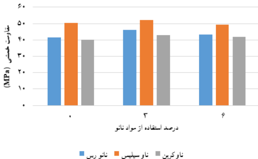
شکل ۶- اثر مستقل درصد مواد نانو بر مدول خمشی نانو چندسازه چوب پلاستیک
