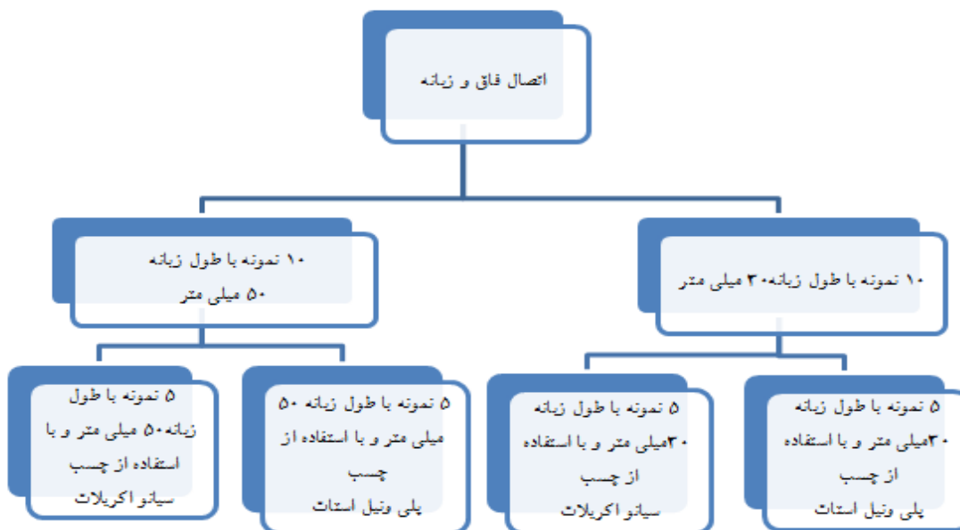
شکل ۲- الگوی شماتیک ساخت اتصال فاق و زبانه تحقیق
