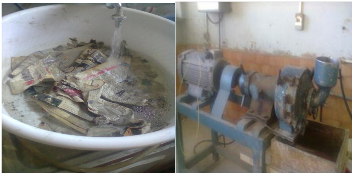
شکل ۳- مراحل خیس کردن روزنامه باطله و دفیبره کرده با دستگاه دفیبراتور
