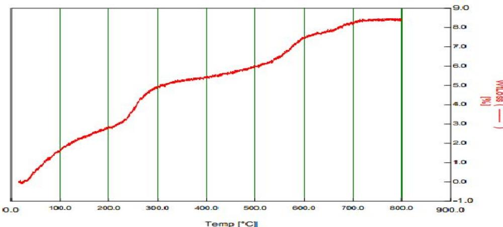
شکل ۲- تست TGA مربوط به نانوذرات  $\text{Fe}_3\text{O}_4$
