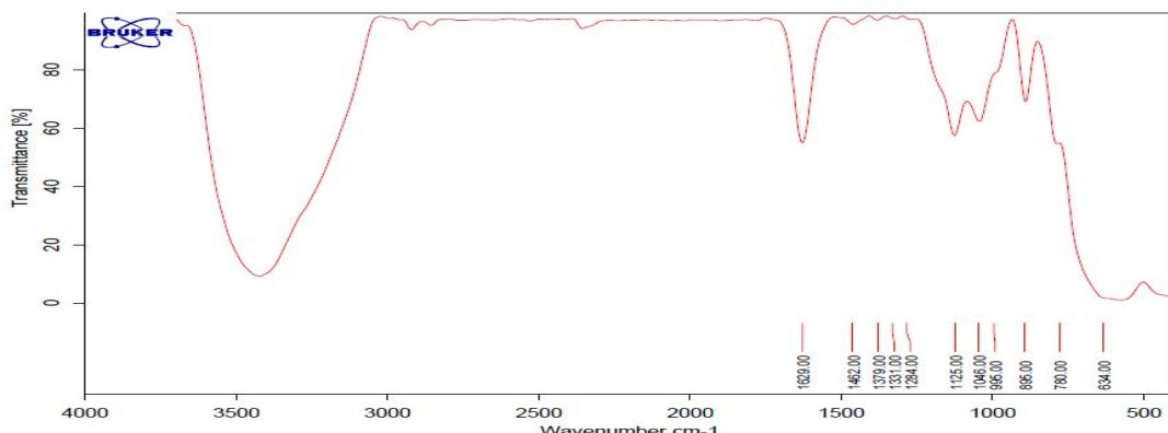
شکل ۱- طیف FT-IR مربوط به نانوذرات  $\text{Fe}_3\text{O}_4$
