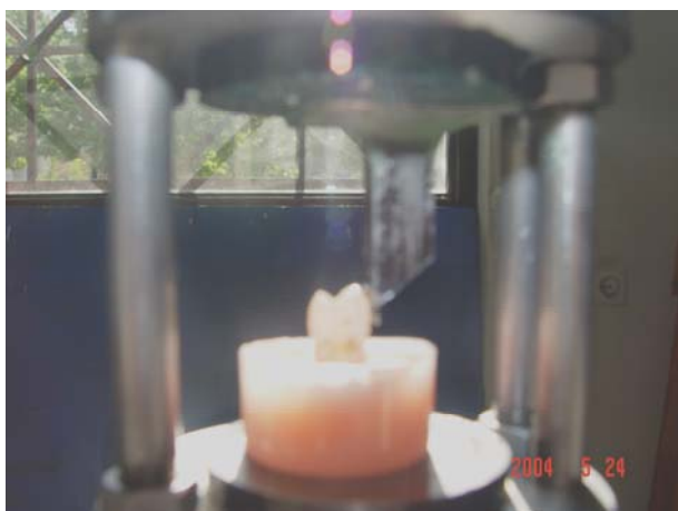
شکل ۲: آزمون نیروی برشی توسط دستگاه اینسترون
