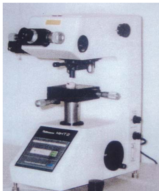
شکل ۳: دستگاه میکروسختی سنجی ویکرز با نام Matsuzawa
