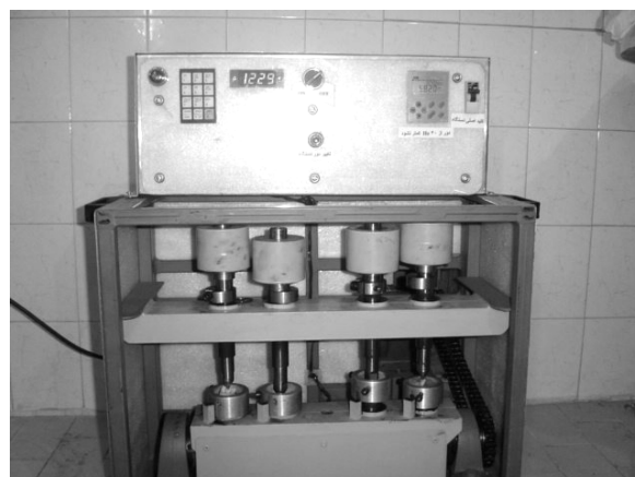
شکل ۴: دستگاه Cyclic Loading و نمونه‌ها در حال آزمایش
