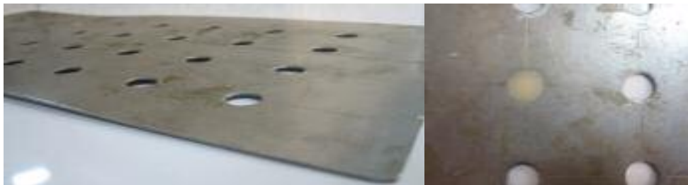
شکل ۱: تصویر قالبهای دیسکی برای نمونه‌های آزمایش حلالیت
