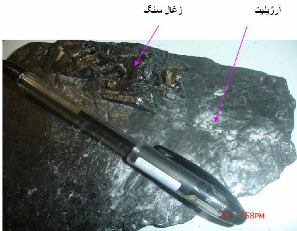
تصویر (۱-۲) نمونه زغال سنگ دارای آرژیلیت از معدن مزینو
