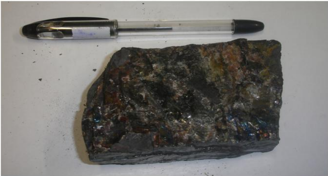
تصویر (۲-۲) نمونه زغال سنگ همراه با ناخالصی اکسید آهن، رس و پیریت از معدن مزینو
