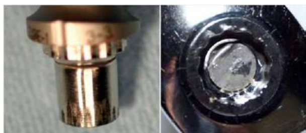
شکل ۶- خوردگی سایشی در ناحیه تیپری و ایجاد پدیده تیپروسیس
