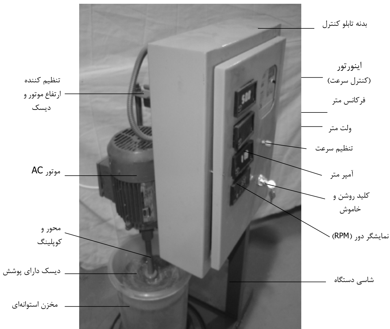
شکل ۴ - تصویر دستگاه آزمایشی
