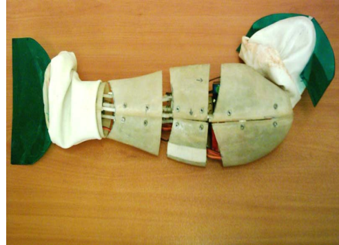
شکل ۵- نمایی از بدنه و پوشش آب بندی شده
