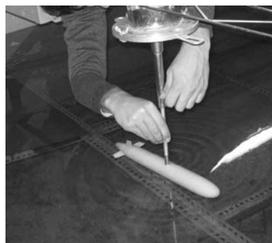
شکل ۹- نصب مدل بر روی ارابه حوضچه کشش
