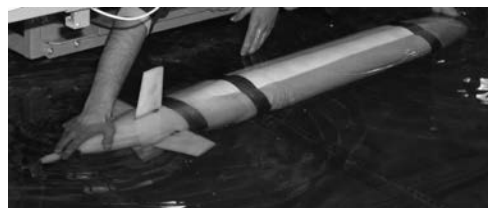
شکل ۱۸- زیرسطحی SUT-2 در حال به آب‌اندازی
