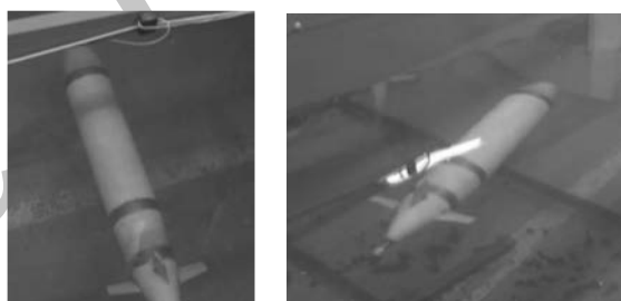
شکل ۱۹- زیرسطحی SUT-2 در حال مانور در حوضچه مرکز پژوهشی مهندسی دریا
