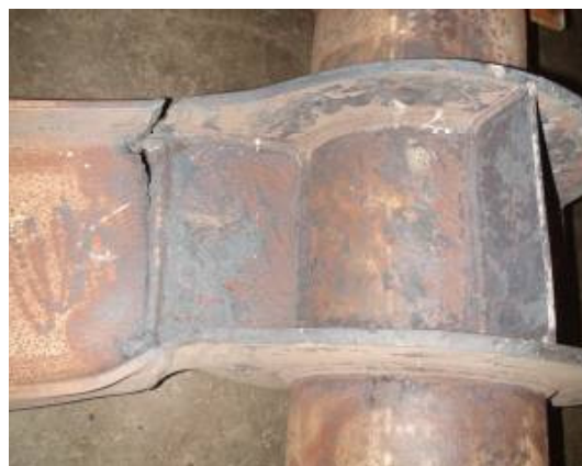
شکل ۱۳- نحوه گسیختگی اتصالات
