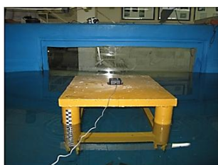
شکل ۵- نحوه استقرار مدل با زاویه ۰ درجه نسبت به امواج
