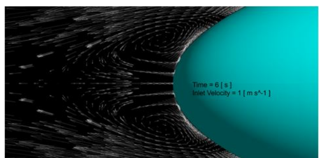
شکل ۱۰- خطوط جریان (چپ) و بردارهای سرعت (راست) در پشت جسم بیضیگون در حرکت شتابدار در راستای طولی در ۳ زمان مختلف
