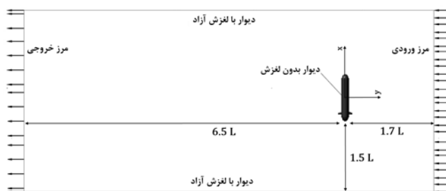
شکل ۱۲- میدان حل و شرایط مرزی در شبیه سازی های آزمون های کشش محوری و جانبی
