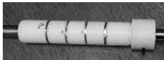
شکل ۱۰- رویه ی داخلی مجهز به ورقه‌های مسی
