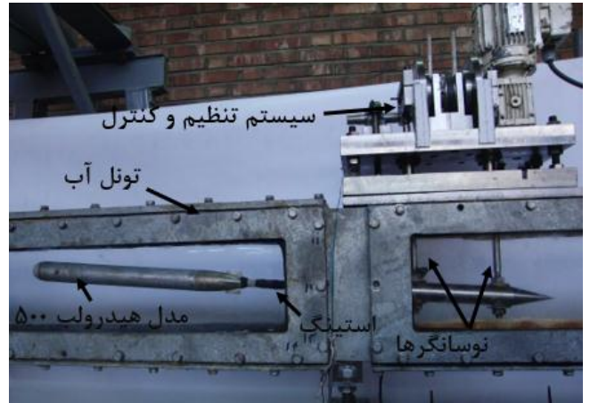
شکل ۳- تجهیزات نصب شده در تونل آب جهت انجام تست های دینامیکی و استاتیکی
