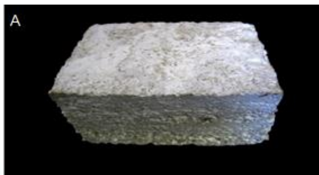
شکل ۲- نمونه سنگ بهسازی شده با آب آهک (A) و نمونه سنگ شاهد (B)
