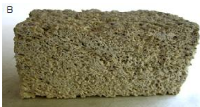
شکل ۲- نمونه سنگ بهسازی شده با آب آهک (A) و نمونه سنگ شاهد (B)
