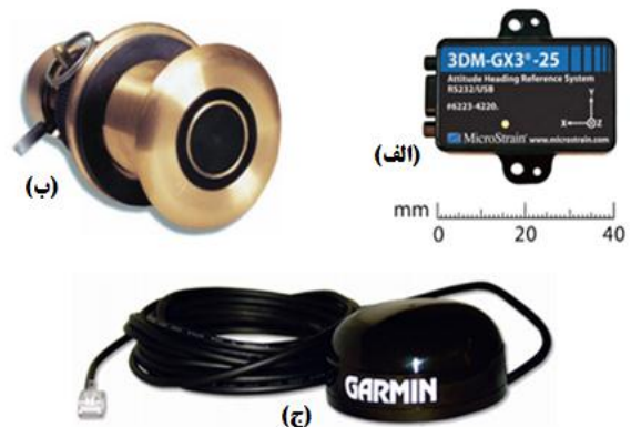
شکل ۳- تجهیزات بکار رفته (الف): واحد IMU، ب: حسگر سرعت، ج: گیرنده‌ی [۲۰-۱۸]
