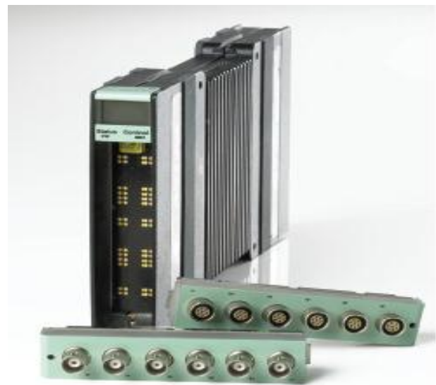
شکل ۵: دستگاه داده برداری LAN-XI شرکت B&K
