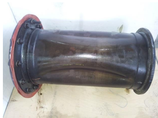
شکل ۱۷- نمونه فولادی بعد از کمانش و ضریب ۰/۴ در آزمایش
