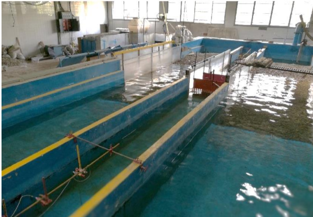
شکل ۵- فلوم آزمایشگاه و جانمایی مدل فیزیکی مورد آزمایش
