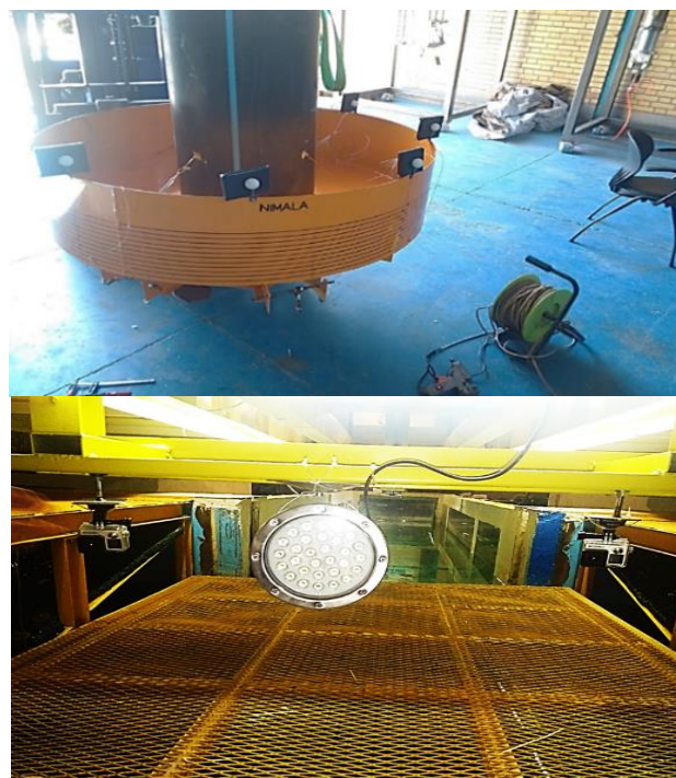
شکل ۱۴- نقاط مارکر سفید رنگ با زمینه تیره نصب شده بر روی SPM (تصویر بالا) و نمایی از قرارگیری دو دوربین و پروژکتور هنگام تصویر برداری از SPM (تصویر پایین)
