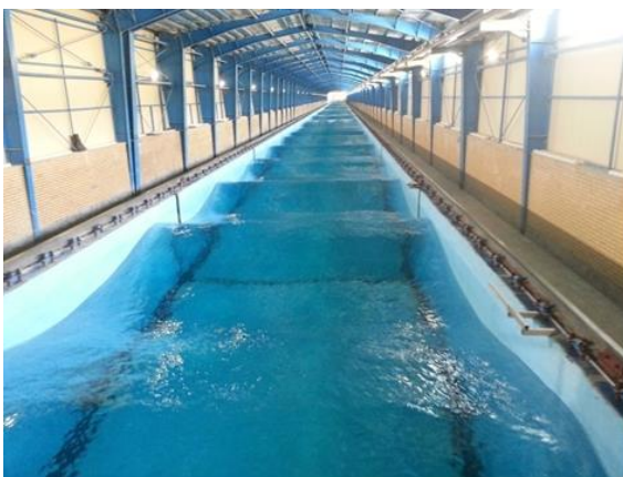
شکل ۱۳ - موج منظم تولید شده توسط موجساز در فلوم آزمایشگاهی
