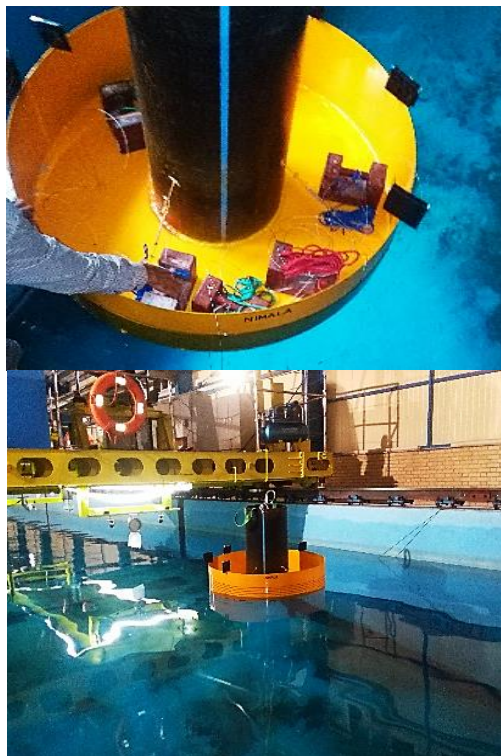
شکل ۱۵ - نحوه‌ی مهار کردن SPM (تصویر بالا) و وضعیت قرارگیری دوربین‌ها نسبت به SPM (تصویر پایین)
