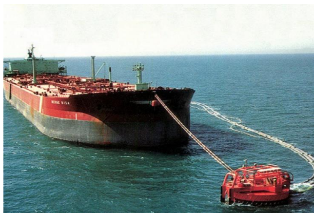
شکل ۲ - نمایی از SPM و شناور به همراه خطوط انتقال نفت و مهاربندی [۲]
