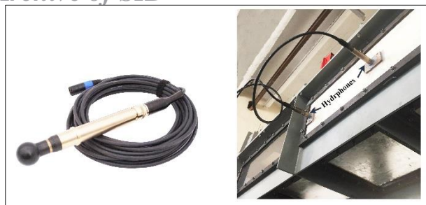
شکل ۱۴ - هیدروفون TC4042 و جانمایی تجهیزات تست
