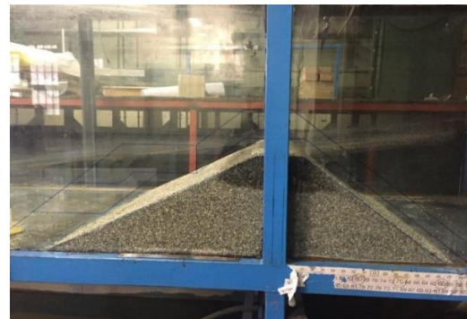
۵- الف- اجرای هسته موج شکن سکوی چندلایه
