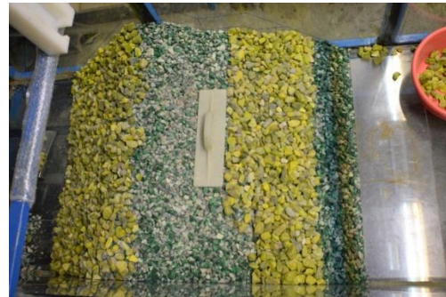
۵-ج- اجرای کلاس II موج شکن سکویی چندلایه
