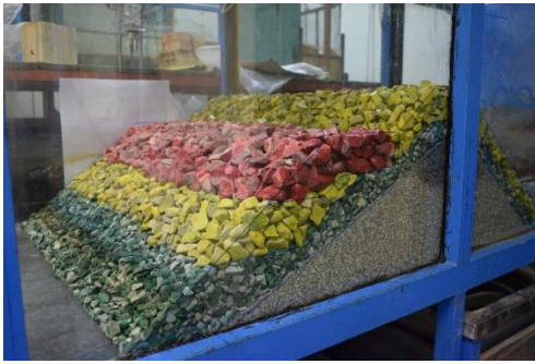
۵-د- اجرای کامل موج شکن سکویی چندلایه
