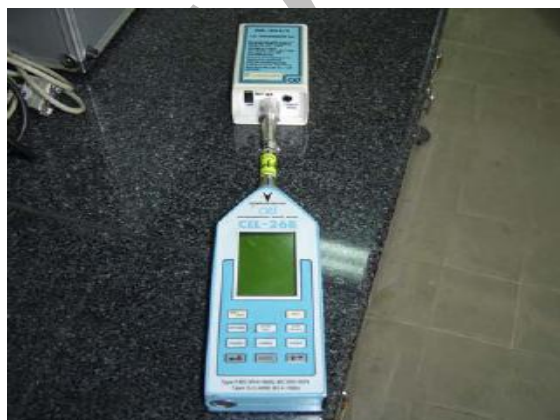
شکل ۳: دستگاه سنجش صدای محیطی در حال کالیبره
