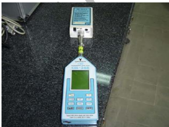
شکل ۳: دستگاه سنجش صدای محیطی در حال کالیبره
