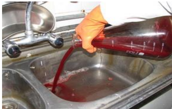
شکل ۱- c: سیستم شستشو به روش سنتی که محلول شستشو وارد فاضلاب می‌شود
