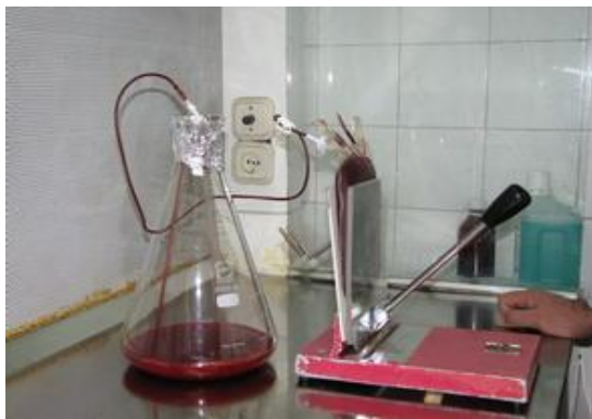
شکل ۱- b: سیستم شستشو به روش سنتی که محلول شستشو پس از سانتریفوژ وارد ظرف باز می‌شود
