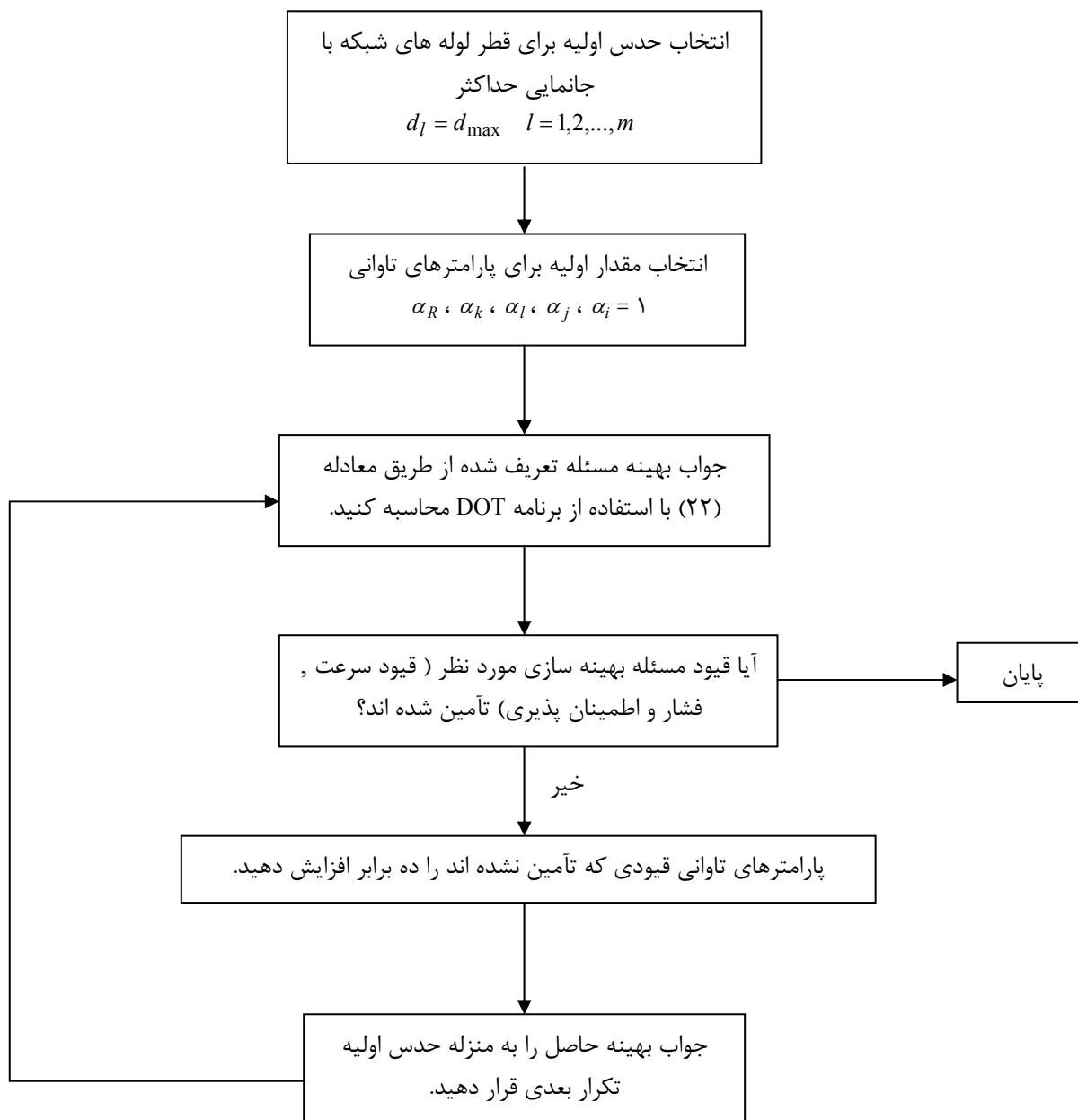
شکل ۴. نمودار شماتیک فرآیند بهینه سازی جانمایی
