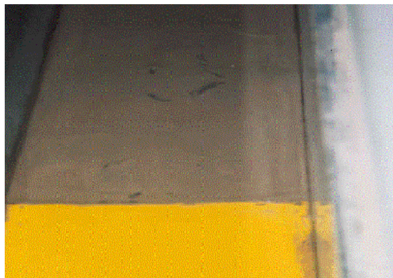
شکل ۷. بستر فرسایش یافته بعد از آزمایش مرحله اول
