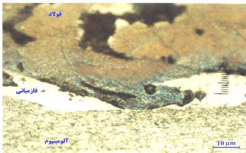
شکل ۳- فاز میانی تشکیل شده در فصل مشترک موجی جوش‌های انفجاری آلومینیوم 2024 به فولاد St-37 [۶]
