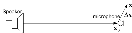
شکل ۴. آرایش بلندگوی ثانویه و میکروفن خطا در ANC
